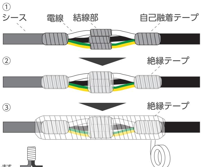
閉端接続子を使用する場合は結線部を上向きに固定し、シースの間から水が浸入しない様に注意します。
